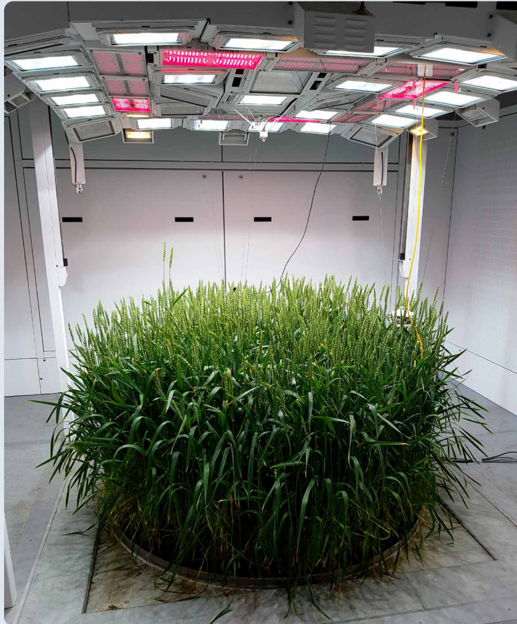
Fig. 2 : Salle à environnement contrôlé : Les expériences d'écotron prévoient des environnements contrôlés pour étudier les impacts du changement climatique sur les écosystèmes et les processus de la biodiversité (Crédit photo : Pierre Delaplace)
